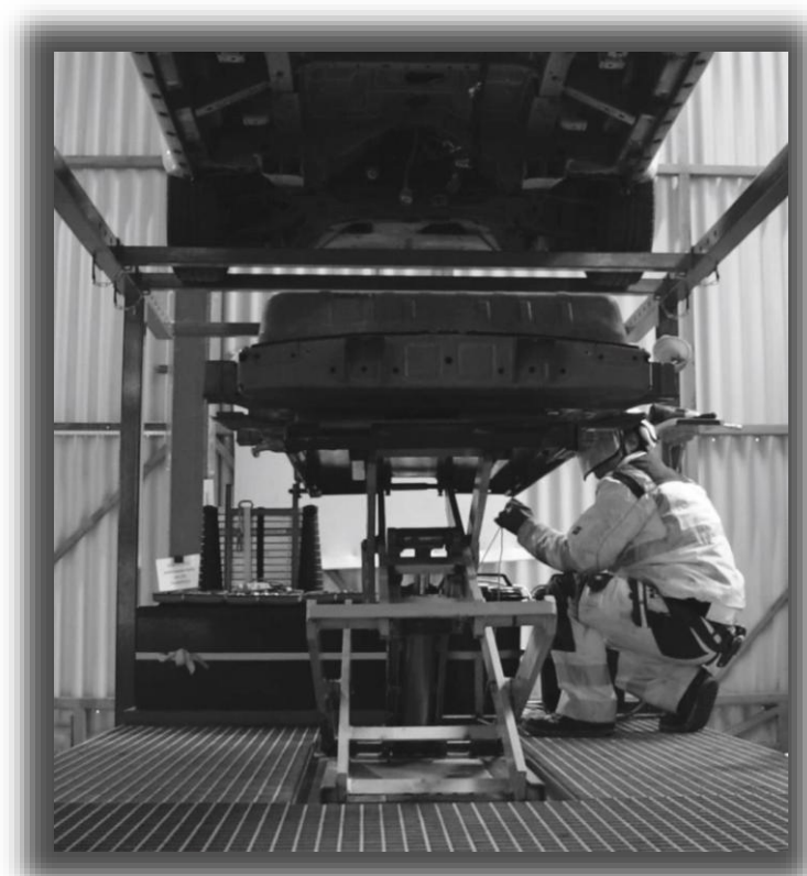
Unser Hochvoltspezialist beim Ausbau einer Hochvoltbatterie
