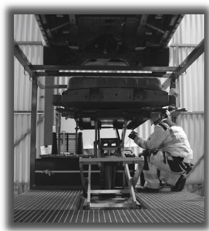
Unser Hochvoltspezialist beim Ausbau einer Hochvoltbatterie
